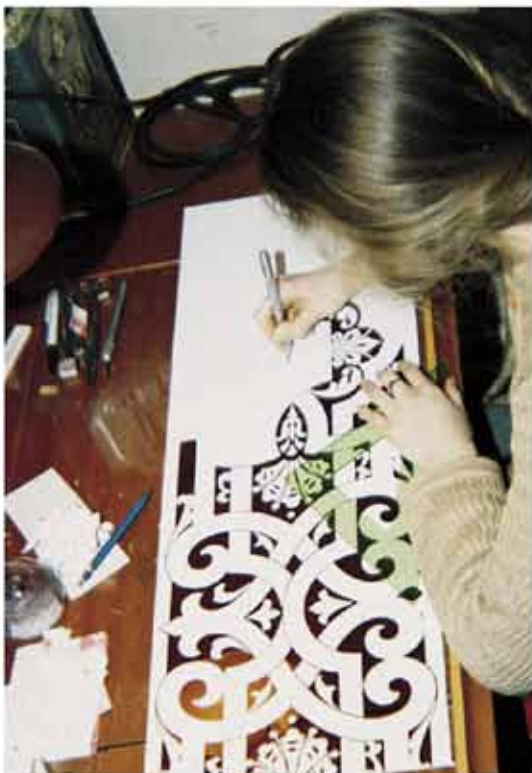
Vyřezávání vzoru do tapety pro pískovaný Vzor vitráže.
