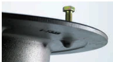
Šroub v přírubě ve slepé díře se dnem, v přírubě není průchozí závitový otvor, tím je utěsnění bezpečně a trvalé
