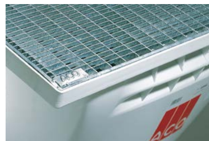
Rošt s oky 30 x 10 mm pochozí do 1,5 kN, pojezdny do 9,0 kN. Pro chodníky a terasy doporučujeme rošt s oky 30 x 10 mm
