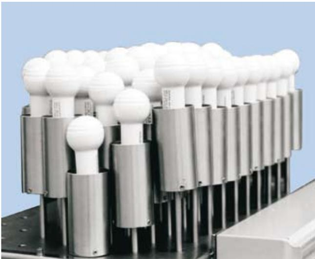
Bild 8: 3-D-Heizfeld zum Kaschieren von Türverkleidungen
