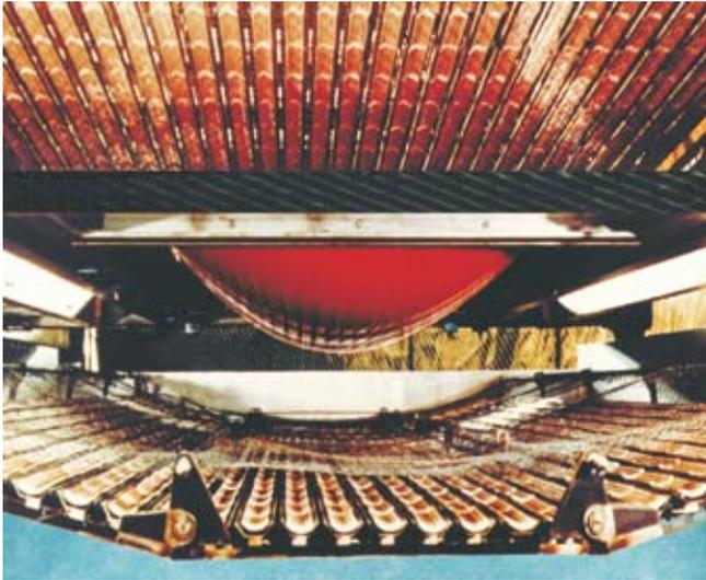
Bild 7: Thermoformanlage für Bootskörper
