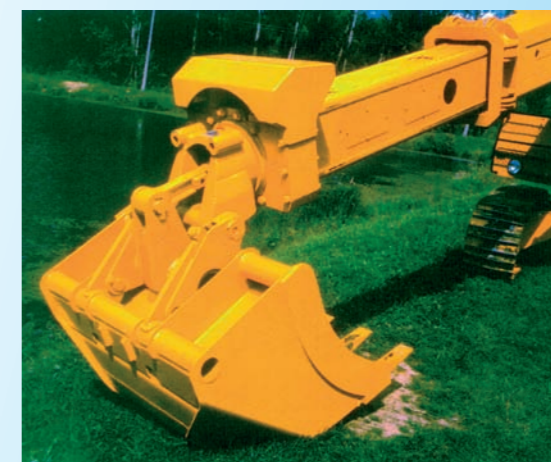
Rýchloupínač pracovného nástroja, otočná hlava Working tool quick-acting fixture and revolving head
