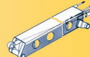
Predlžovacie ramená, dĺžka 1,5 m a 3 m 1,5 m and 3 m extension arms
