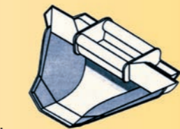
Profilová lopata na hĺbenie priekopov, šírka dna 0,35 m a 0,5 m Profile shovel for the dikes excavation, 0,35 m and 0,5 m bottom width
