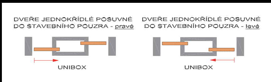
Horizontální řez pouzrem Unibox
