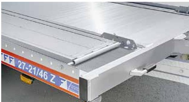
MPV-Plateau: Überfahreinrichtung mit klappbaren Ladeschienen.
