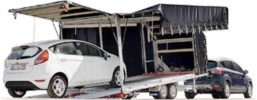
*Die Klappversion: Ausstellbare Heckklappe und Seitenklappen mit Gasdruckfedern.*
