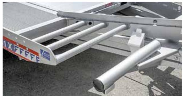
OPV-Plateau: Überfahrbock zur Aufnahme der Überfahr-Rampen eines Blitzladers.
