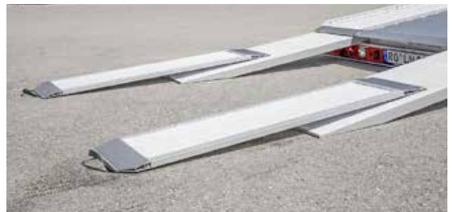
Zusatz-Ladeschienen ermöglichen einen noch flacheren Auffahrwinkel.
