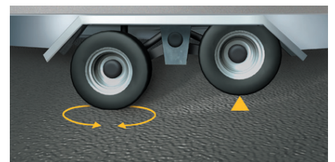
Hinterachse mit Lifeinrichtung: Ermöglicht ein leichtes Rangieren des Anhängers per Hand.
