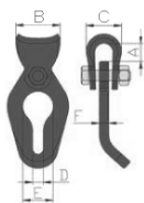
Spojka kluzná zkracovací SKZ / Sliding connector SKZ
