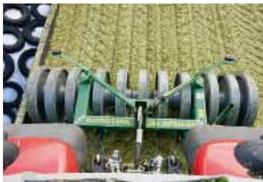
Mit der drei Meter breiten Ausführung lässt sich auch an Silowänden komfortabel arbeiten.
