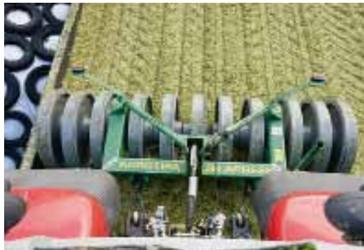
Mit der drei Meter breiten Ausführung lässt sich auch an Silowänden komfortabel arbeiten.
