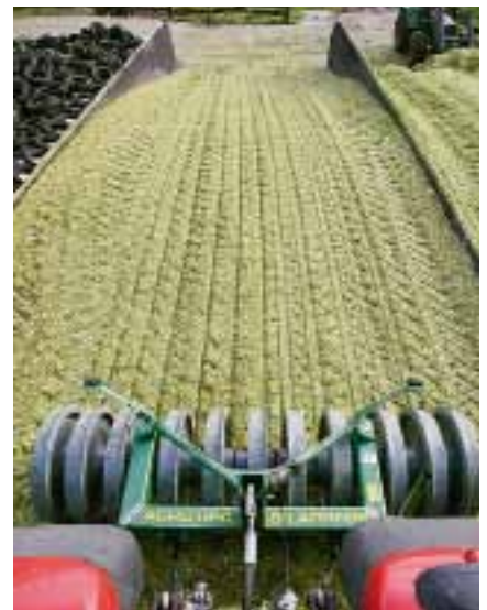
Mit der Walze kann eine sehr ebene Oberfläche zum Abschluss nach oben erzielt werden.
