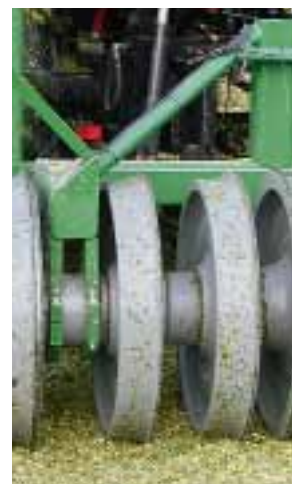
Die Räder sind auf einer durchgehenden Welle gelagert und über eine Verschraubung an den Hauptrahmen geklemmt.
