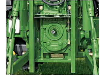
Koncovka vývodového hřídele je otočná s 6 a 21 drážkami.
