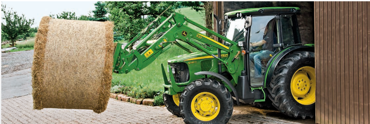
Nejnižší výška řady 5G činí pouze 235,4 cm (s pneumatikami 14.9R28) – vhodné pro vrata s nízkým průjezdem.
