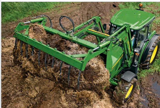
Součástí výbavy čelního nakladače je vše, co potřebujete: rám pro montáž, ochranný rám kapoty, mechanický dvojčinný joystik s přepínačem, vývody vnějších okruhů s přetlakovým odpouštěcím ventilem a sdruženým připojováním.
