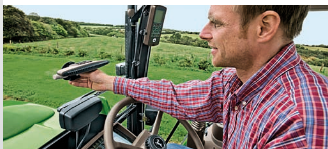
Každá dioda na světelné liště GreenStar ukazuje 10-ti centimetrovou odchylku od ideální stopy.
