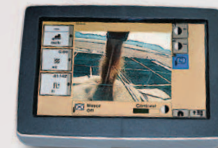
Funkce integrovaného videa v dotykovém displeji GreenStar 3 umožňuje dokonalou vizuální kontrolu jak zadní části sklízecí mlátičky, tak zásobníku zrna nebo vyprazdňovacího šnekového dopravníku. Je-li instalována kamera, poskytuje videosystém vynikající a individuálně nastavitelné záběry.
