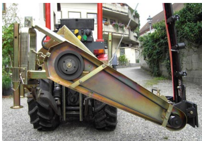
Mechanischer Antrieb über Keilriemen
