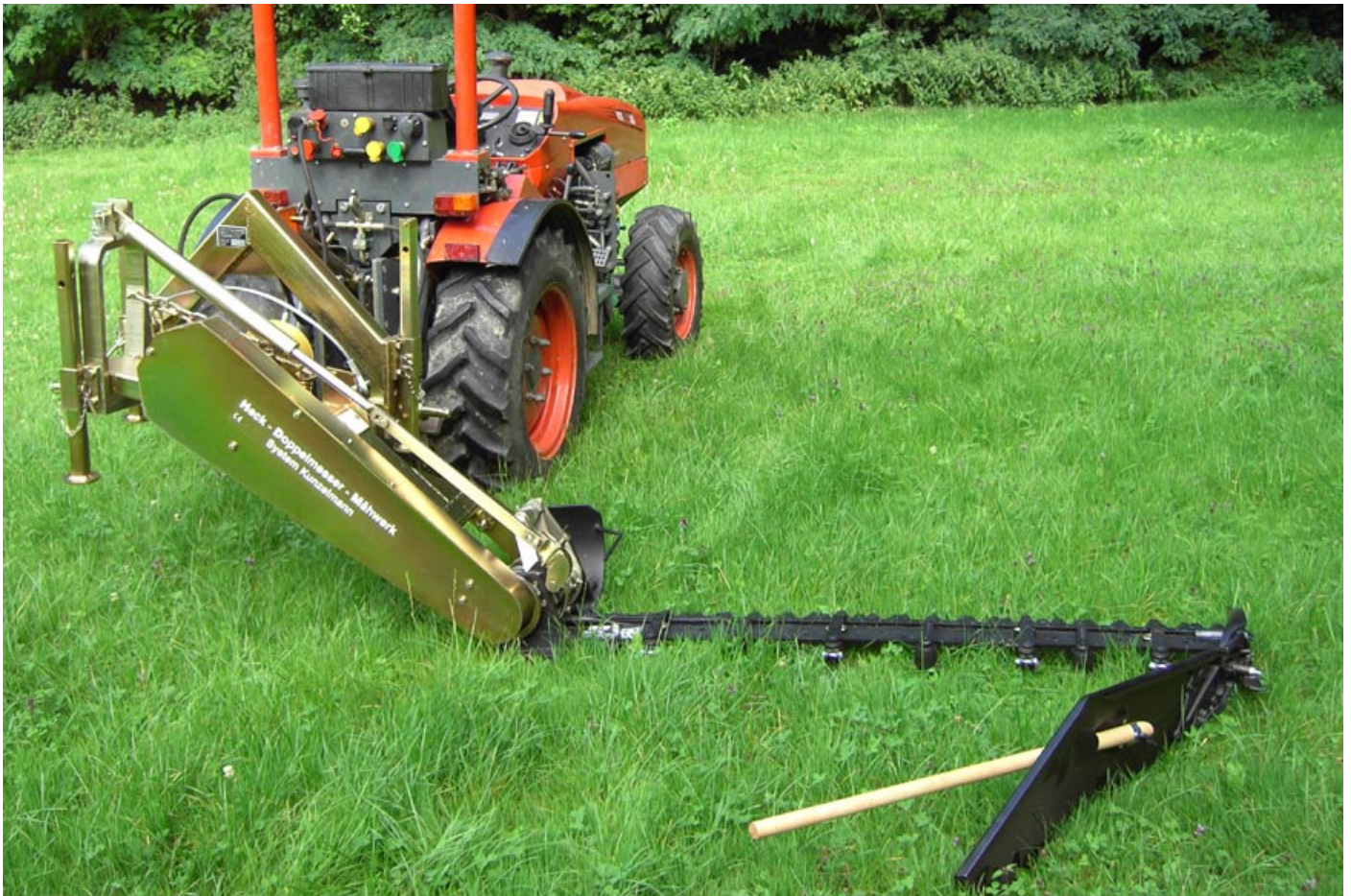
Häckmähwerk, Rechtsausleger, mechanischer Antrieb, Schwadblech rechts
