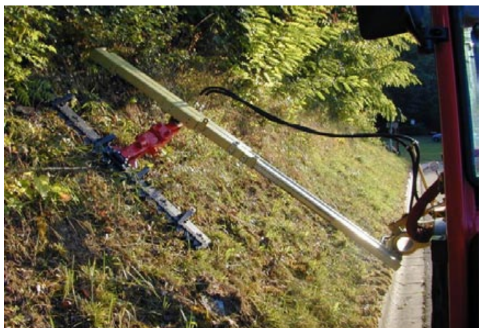
Weinbaumähwerk mit hydr. Mittelantrieb
