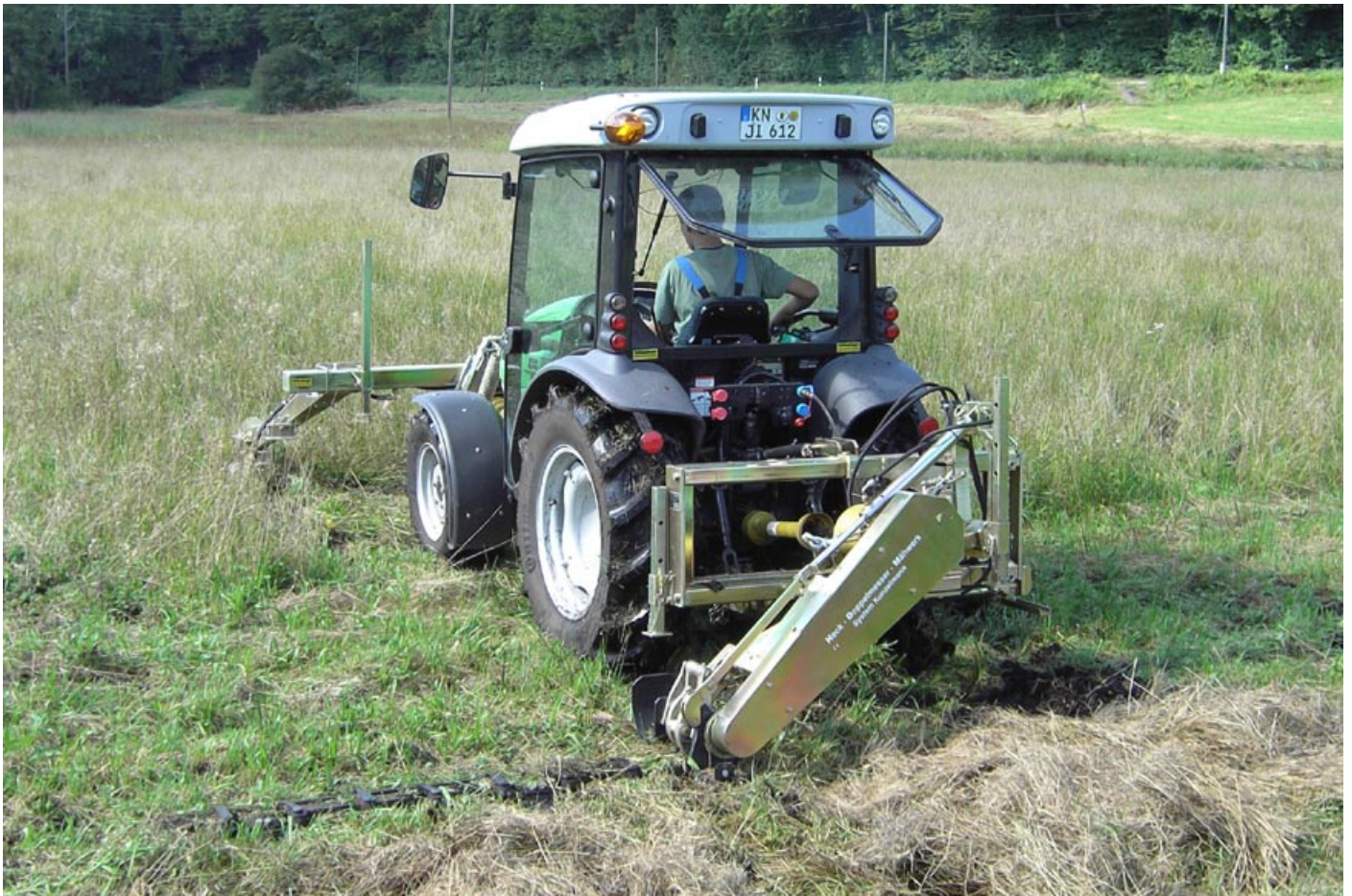
Kombination Front- /Heckseitig, mechanischer Antrieb über Zapfwelle
