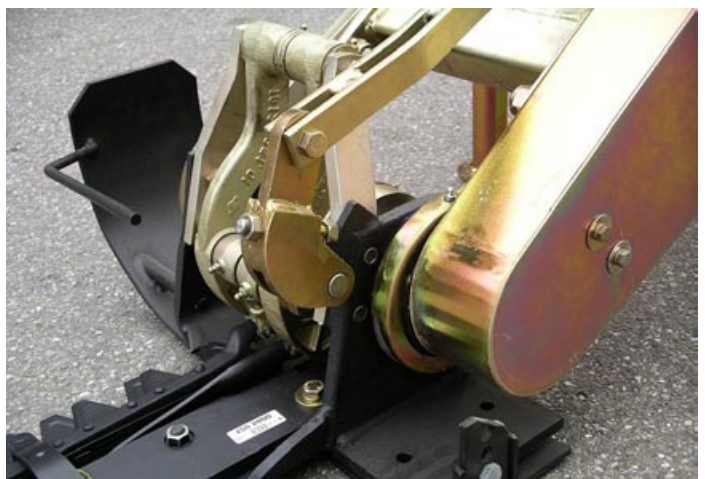
Mechanischer Antrieb (Kurbeltrieb)
