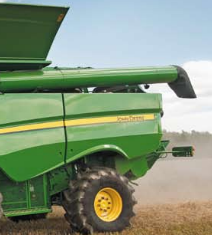
Zesílený šikmý dopravník řady S Je schopen podávat ještě více materiálu.
