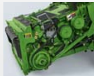
Pěti- rychlostní pohon šikmého dopravníku Vysoký krouticí moment a možnost volby správné rychlosti z kabiny.
