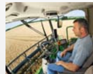
Lepší přehled Dlouhý šikmý dopravník umožňuje obsluhu vidět lépe do lišty. Lepší přehled znamená lepší nastavení, méně cizích předmětů v liště a méně poškození.
