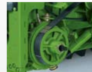
Reverzor vkládacího ústrojí Reverzor je schopen spolehlivě uvolnit zablokovaný materiál.
