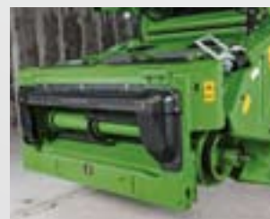
Snadné seřízení. Čelní úchytnou desku lze snadno úhlově nastavit. Toto nastavení je velmi významné a může podstatně zjednodušit a urychlit sklizeň. Podle podmínek je možné si lištu úhlově nastavit mírně na „patu“ nebo na „špičku“.
