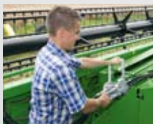
Rychloupínací multispojka Připojení žacího válu k mlátičce je otázka chvilky.
