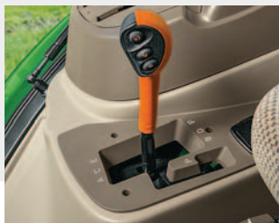
Převodovka PowrQuad Plus: jedna páka s integrovaným spojkovým tlačítkem a řazením 4 stupňů při zatížení.
