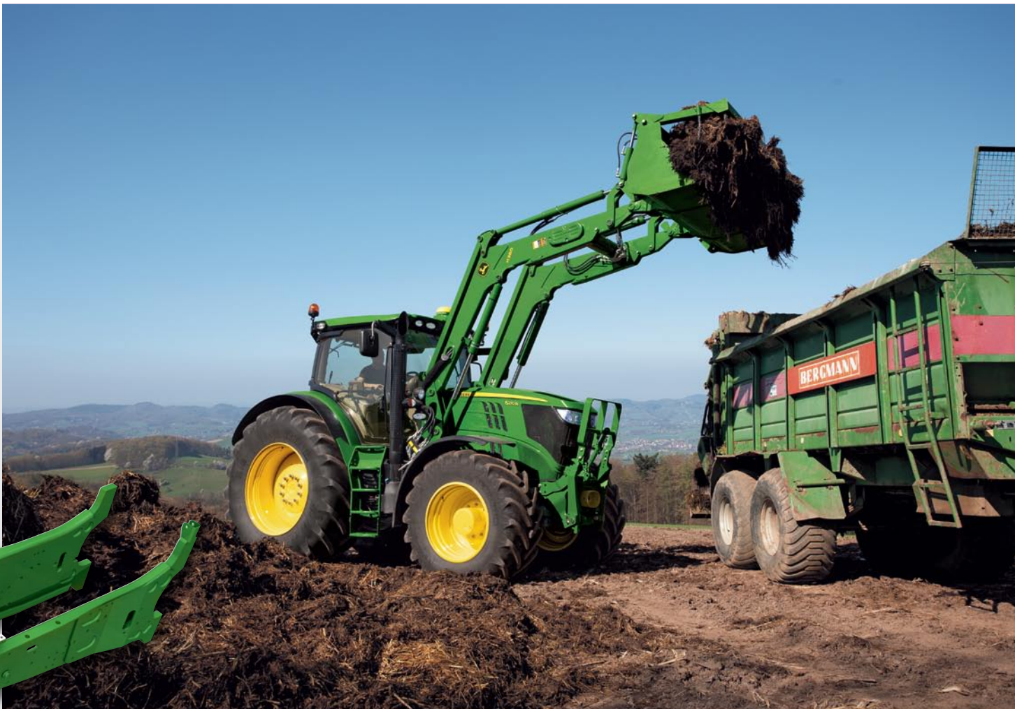
Celorámová konstrukce umožňuje traktoru pracovat a převážet těžké nářadí.
