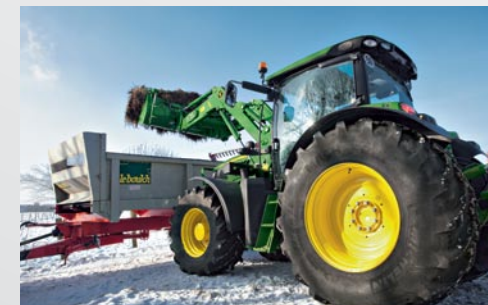
Nakladač H310 se vyznačuje kompaktní konstrukcí, ideální všude tam kde je málo místa. Základní parametry jsou nosnost až 1,85 t a 3,8 m maximální výška.*
