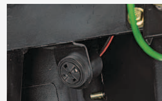
Zvukový signál při jízdě vzad Z bezpečnostních důvodů je při couvání traktoru automaticky zapnuta zvuková signalizace.
