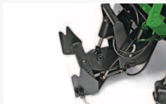
Závěs Quick Hitch s vývodovým hřídelem Pro rychlou změnu nářadí.
