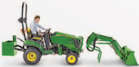
1. Najed'te traktorem mezi ramena nakladače.
