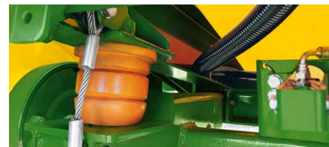
Double link odpružení nápravy pro klidnější a přesnější postřik a rychlejší transport.
