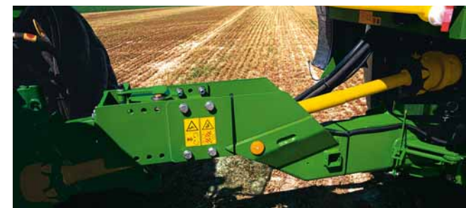
Úzká, tažná oj zabraňuje kontaktu s koly traktoru.
