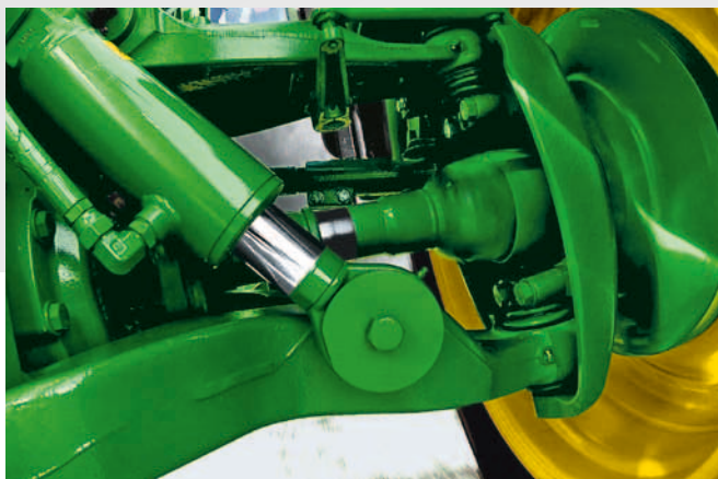
Nezávislé odpružení (ILS) zajišťuje u traktorů s koly řady 8R maximální trakci a optimální pohodlí při jízdě.
