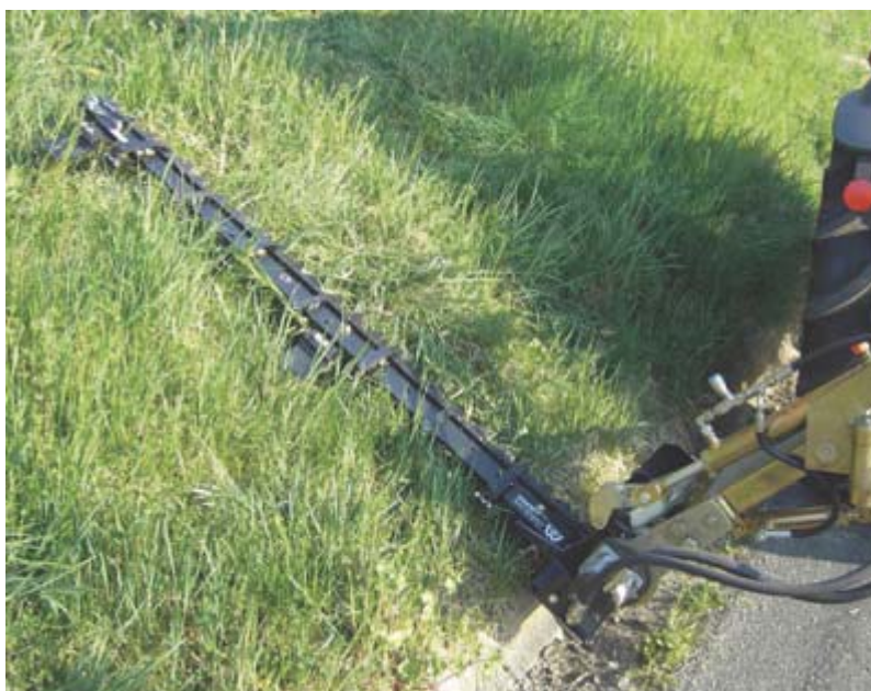
DMH-H- 1,65 m Sečení svahů protisvah až do +90^\circ a svah podél cest až do -70^\circ .
