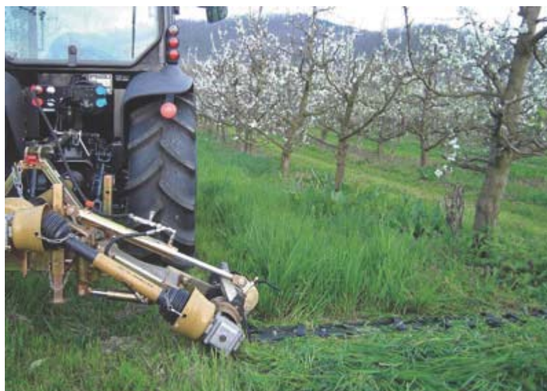
DMH-M- 1,65 m Mechanický pohon s úhlovou převodovkou – bezstupňové seřizování výšky pokosu.
