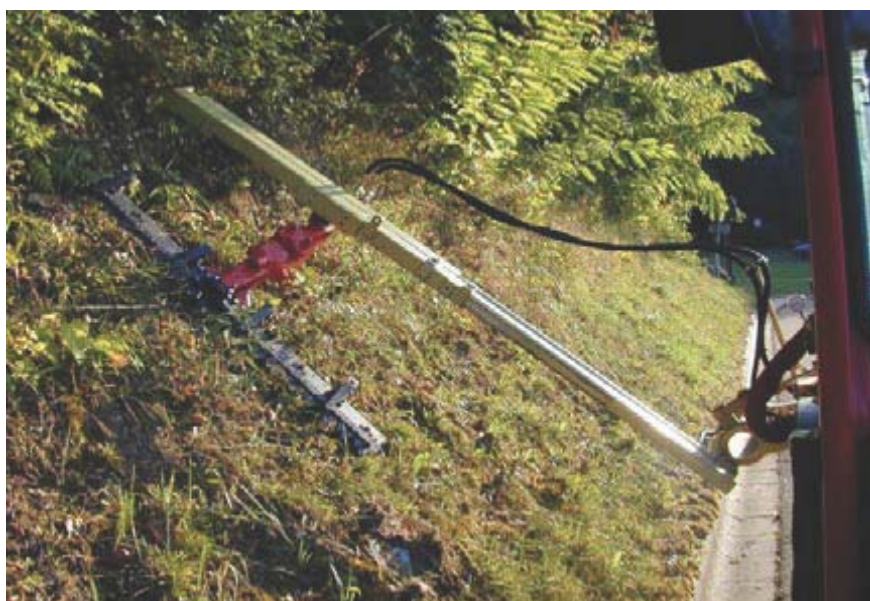
Sečení protisvahů strojem Systemtechnik KUNZELMANN
