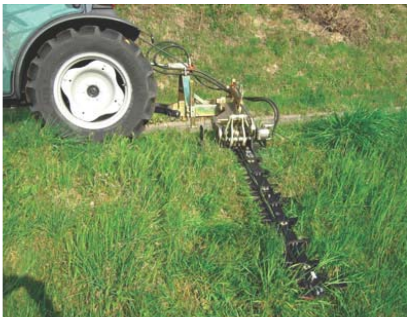
DMH-H- 1,65 m Sečení svahů protisvah až do + 90° a svah podél cest až do -70°. Plynulé nastavení pracovního úhlu
