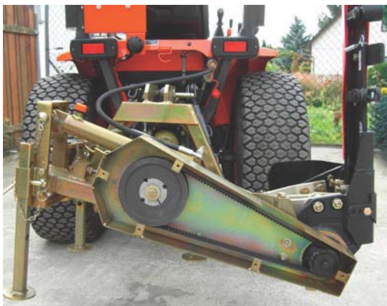
Mechanický pohon klínovým řemenem
