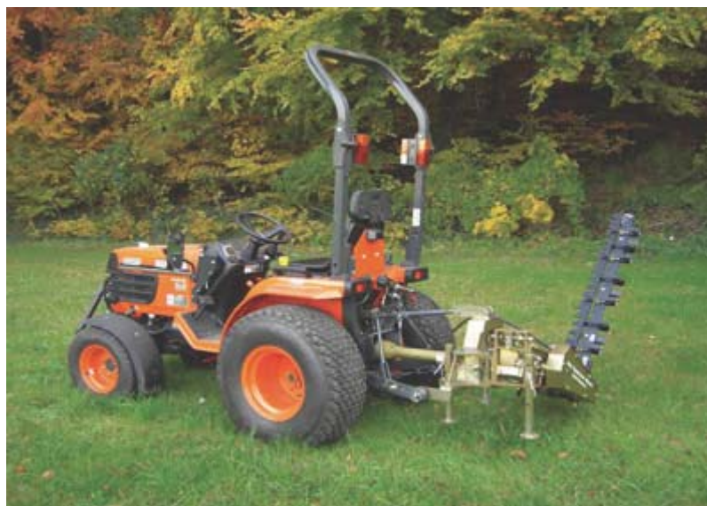
DMH-M- 1,65 m Mechanický pohon s úhlovou převodovkou
