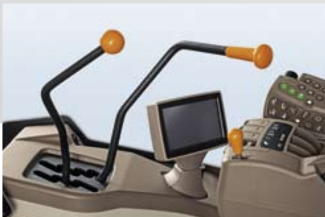
Převodovka PowrSync Snadné ovládání a klidnou jízdu zajistí i základní převodovka s 24/6 stupni.
