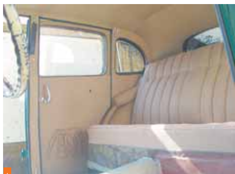
„Čalounění na veterány zhotovují dle původního čalounění nebo dobových fotografií a dokumentace knihy. Zachovávají přitom 100% původnost a dobové zpracování. Zákazníkům doporučuji původní čalounění nevyhazovat, zachovat pro lepší představivost (i když je zcela zničené). U zajímavých a hodných starých aut je lepší, když si díly rozebereme sami, zjistíme tak více o původním zpracování.“
